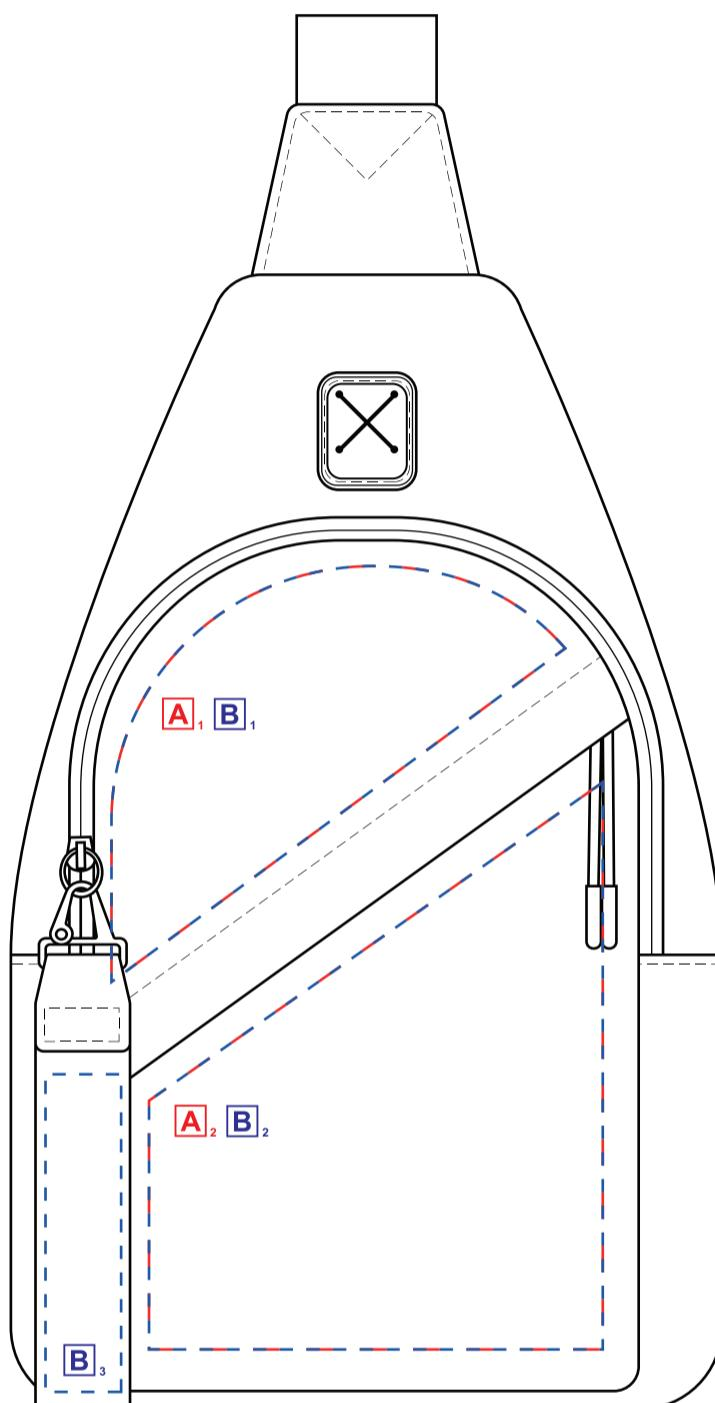
**Метод нанесення:****A - шовкодрук: A1 - max h 120 x 110mm, A2 - max h 120 x 150mm****B - термодрук: B1 - max h 120 x 110mm, B2 - max h 120 x 150mm, B3 - max h 84 x 20mm**
